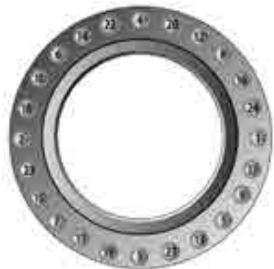
Fig 37 - Séquence pour 24 boulons
