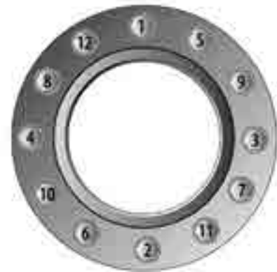
Fig 34 - Séquence pour 12 boulons
