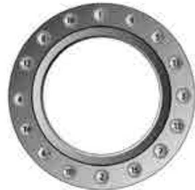
Fig 35 - Séquence pour 16 boulons
